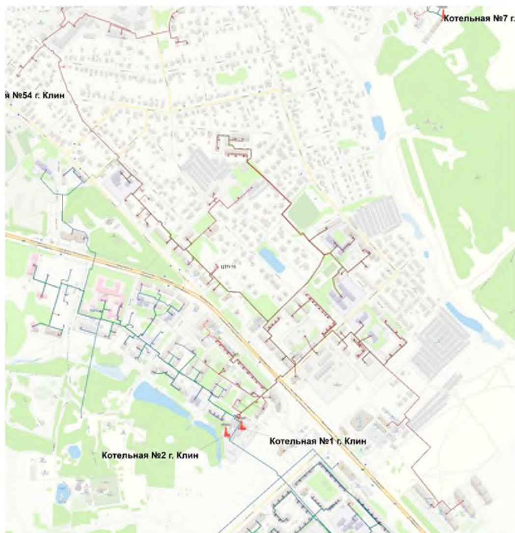
Рисунок Ошибка: источник перекрёстной ссылки не найден.5 – Зона действия котельной № 1, расположенной по адресу: г. Клин, ул. Мечникова, д. 13 с нанесением потребителей, отключенных в связи с аварийной ситуацией
